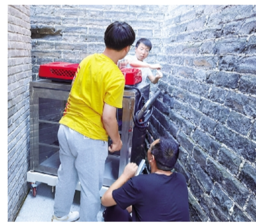
研究团队在西安城墙马面将缪子仪器安放到测量点。 兰州大学供图
