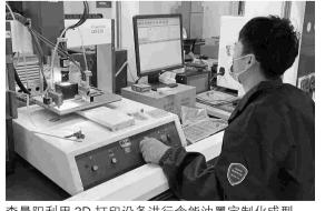
李晨阳利用 3D 打印设备进行含能油墨定制化成型。
