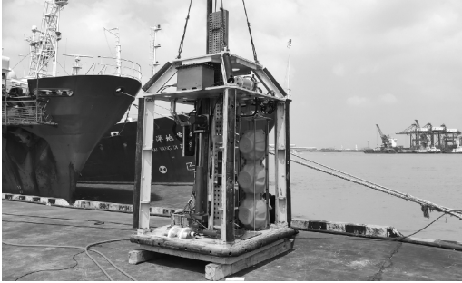
王月供图 海底滑坡光纤监测系统。
