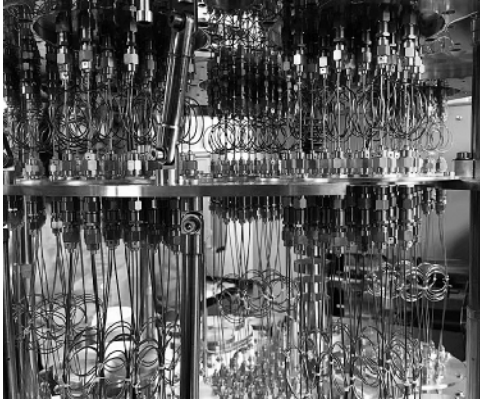
IBM 量子计算机内部的低温稀释制冷机 图片来源:IBM 研究实验室
