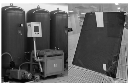
▲ 气体修复设备和修复后的大面积钙钛矿薄膜。
