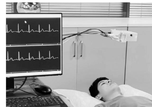
毫米波雷达非接触心电图实时监测。
