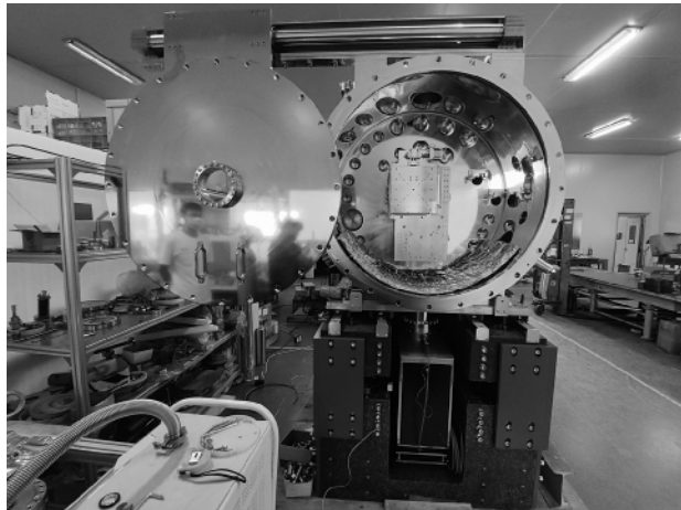
▲HEPS首台自研液氮冷却单色器总体。 ▶HEPS首台自研镜箱总装。 中科院高能物理研究所供图
