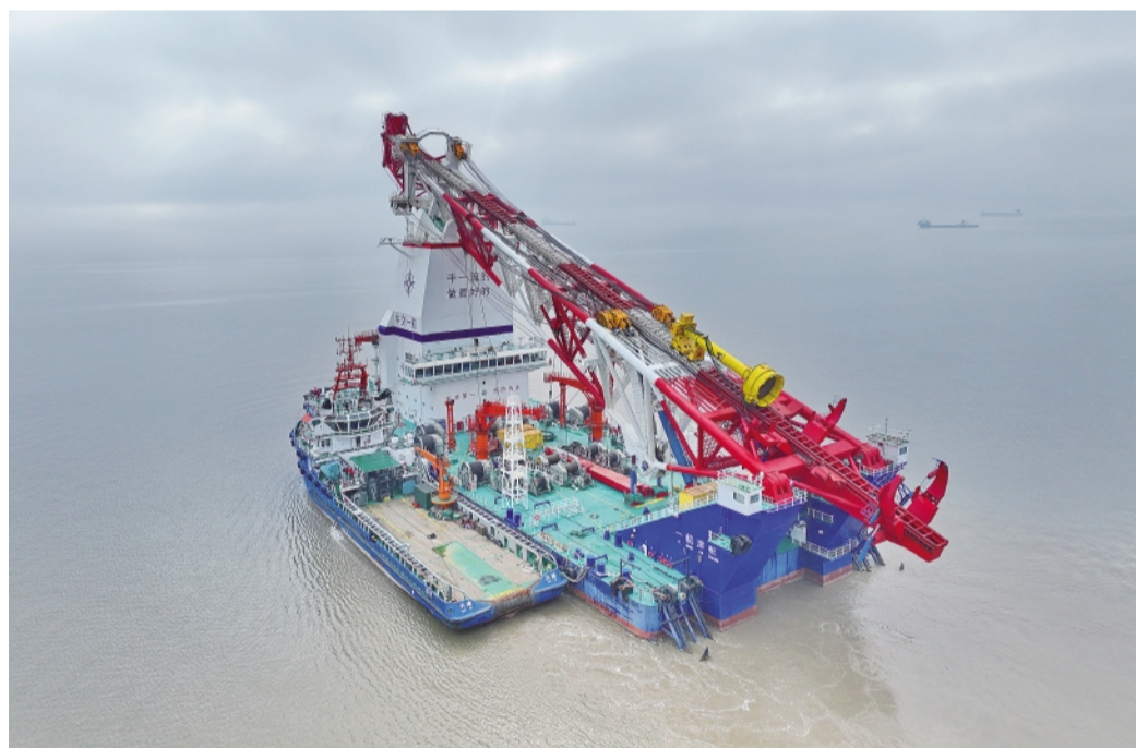
近日,江苏南通,世界首艘140米级打桩船“一航津桩”在振华重工启东海洋工程码头启航,赴浙江舟山参与大桥建设。
