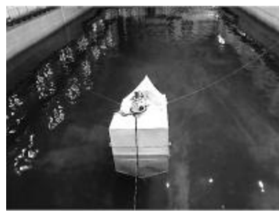
单浮体气动式波浪能发电模型。郑望舒供图
