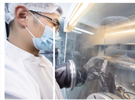
样品在充氮无氧手套箱中打开密封。
