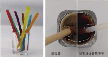
天然的“可食用”原料,并且加工过程不涉及有机溶剂的引入,是一种安全可食用的吸管。由于三维纳米纤维网络以及海藻酸钠在三维网络中的贯穿,让这种吸管的强度、模量和韧性是纸吸管的数倍以上。这就意味着,在同样的性能要求下,细菌纤维素基吸管可以做得比纸吸管更薄。
