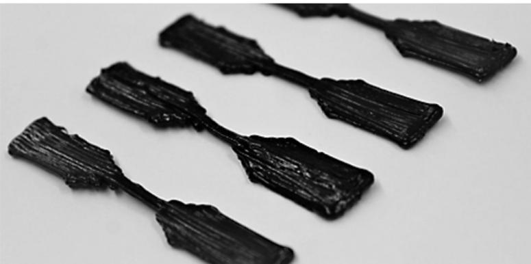
3D 打印的纳米复合材料拉伸试验样品。
