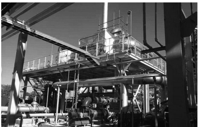
中国石油独山子石化公司乙烯/聚烯烃尾气催化净化装置。中国科学院大连化学物理研究所供图
