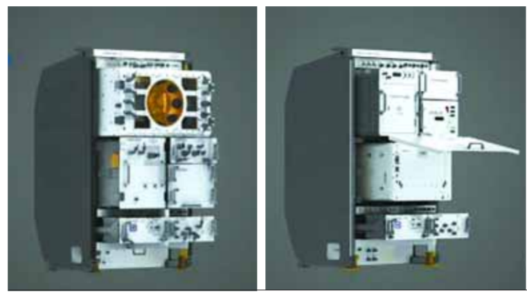
左图为无容器材料实验柜，右图为高微重力科学实验柜示意图。中科院空间应用工程与技术中心供图
