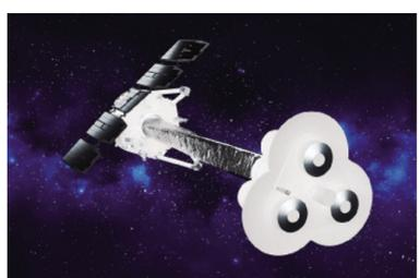
IXPE 上的 3 台望远镜在发射后会延展 4 米。
