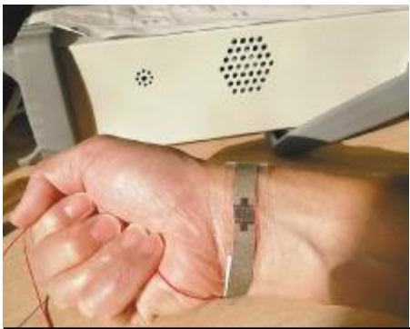
基于新方法的传感器可用于脉搏监测。 北京航空航天大学供图
