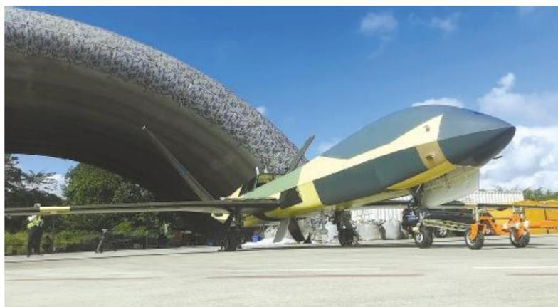
11 月 27 日，2021 年无人机海陆空立体协同观测科研试验正式启动。搭载多种气象载荷的翼龙-10 无人机在高空与海面浮标、气球探空系统、地面垂直遥感观测设备组成立体观测网络，对多气象载荷及无人机平台进行验证。
