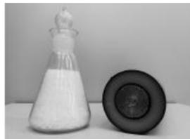
110千伏电缆绝缘材料及电缆制品
