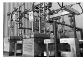
兆瓦级质子交换膜(PEM)水电解制氢系统。
