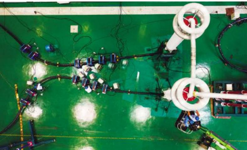
9月2日,在国网舟山供电公司海洋输电工程技术实验室内,工作人员对完成试验后的国产 535 千伏直流电缆进行最后检测作业(无人机照片)。
