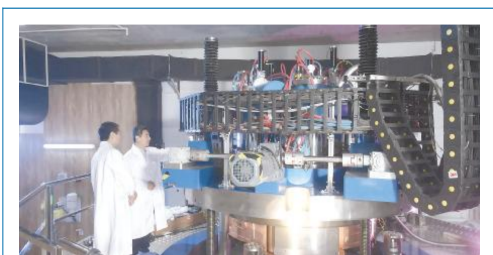
调试中的 230MeV 超导回旋加速器。中国原子能科学研究院回旋加速器研究中心供图
