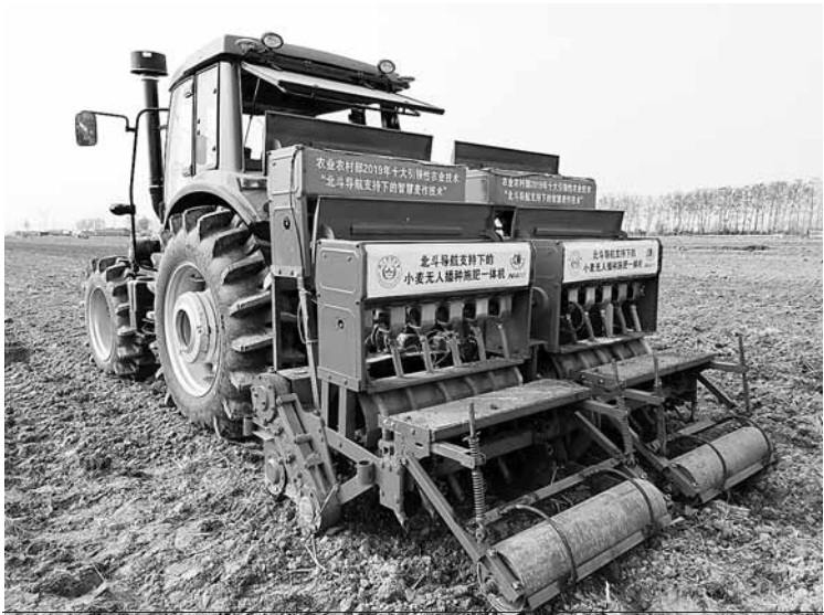
北斗导航支持下的 小麦无人播种施肥一体机在田间作业。 曹强供图
