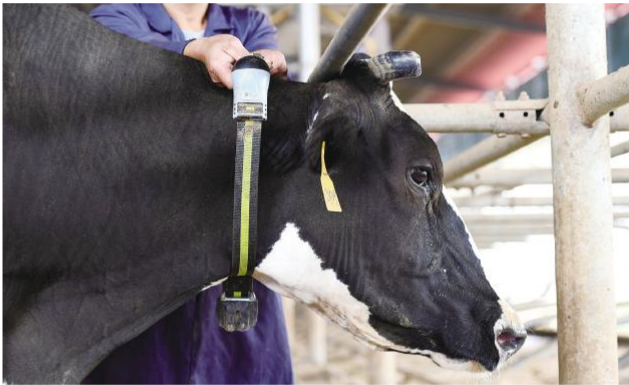
这是 7 月 7 日在河北省石家庄市行唐县康泉牧场牛舍拍摄的奶牛项圈,通过项圈可监测奶牛反刍、发情等身体状况。
