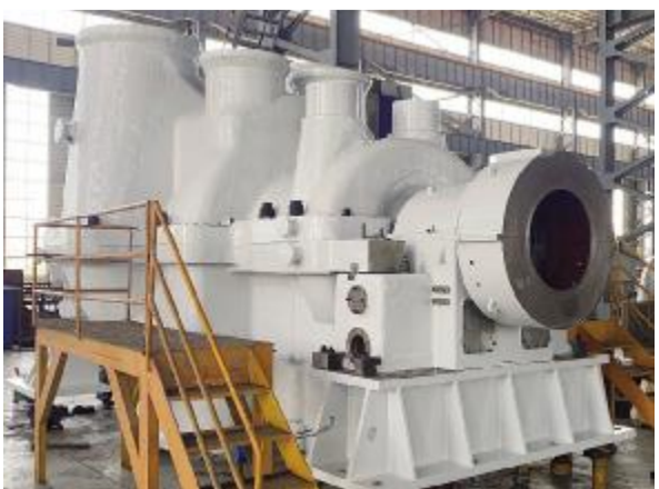
国际首台 100 兆瓦先进压缩空气储能系统膨胀机 中国科学院工程热物理研究所供图
