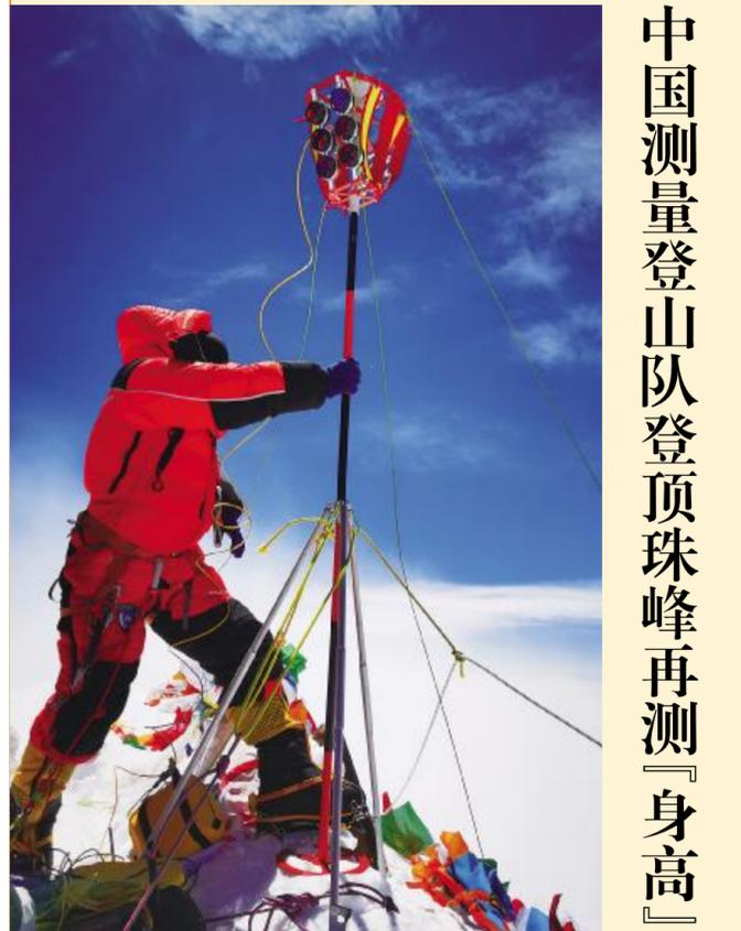
5月27日,2020珠峰高程测量登山队队员在峰顶开展测量工作。当日11时整,中国8名队员登顶“地球之巅”珠穆朗玛峰,为珠峰“量身高”。这座6500万年前从海底隆升而成的喜马拉雅山脉主峰,时隔15年后再次迎来中国测量队伍。他们将在峰顶竖立标杆,安装GNSS天线,开展各项峰顶测量工作。45年前的今天,中国人首次将标杆带至珠峰峰顶。
