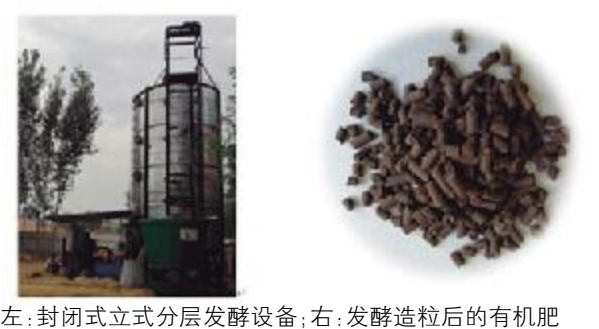
左：封闭式立式分层发酵设备；右：发酵造粒后的有机肥
