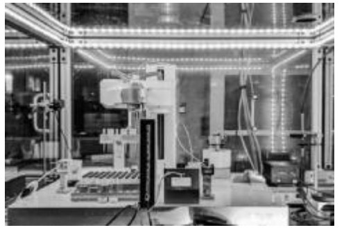
艾达是一台由人工算法驱动的机器人，可以帮助英属哥伦比亚大学的研究者找出新的太阳能电池设计方案。
