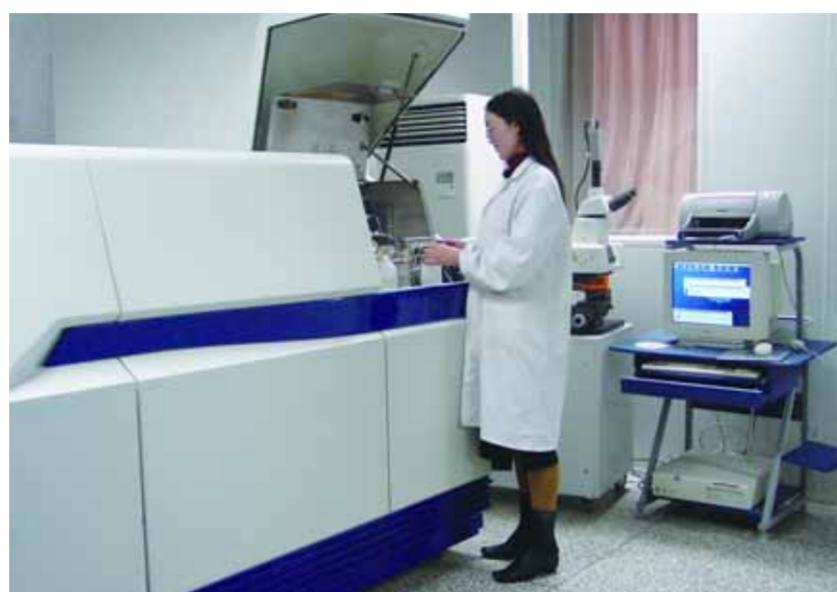
青海盐湖所级公共技术服务中心技术人员王秀芳用电感耦合等离子体质谱仪分析测试样品。 青海盐湖所供图
