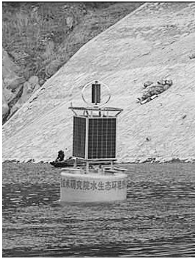
位于汉丰湖下游的高阳平湖的“浮标”——水生态环境原位感知系统。
