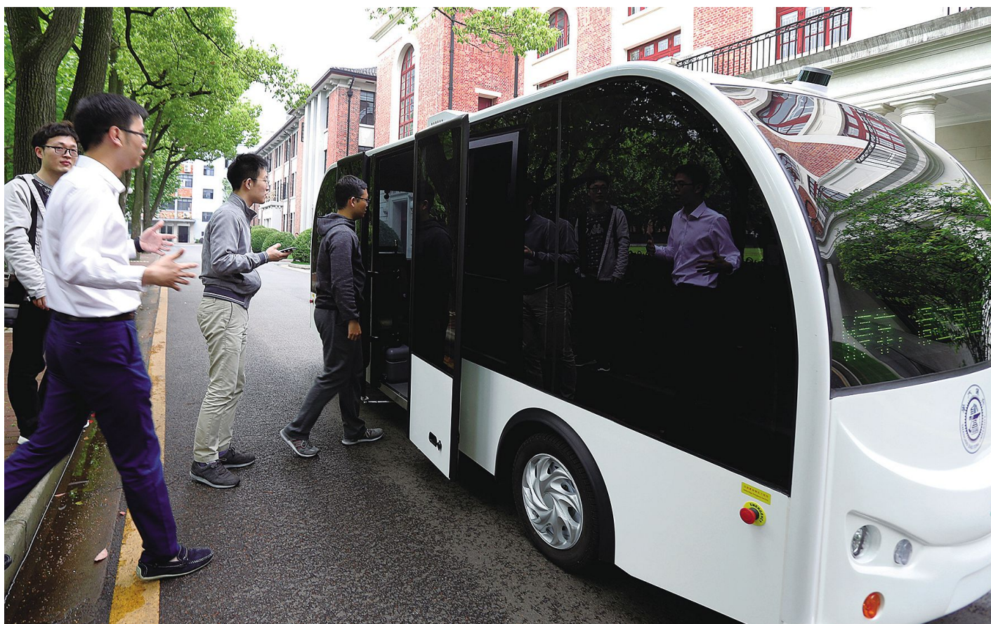
5月8日,由上海交通大学电子信息与电气工程学院教授杨明团队与青飞智能联合研制的无人驾驶小巴,行进在该校徐汇校区。只要在微信上扫码呼叫,无人小巴接到指令后就能自动来接送,车上的自动驾驶系统采用了感知地图匹配的方法,通过激光点云对无人车进行定位和导航,不仅能自动驾驶,还能自动躲避行人。据了解,该无人小巴采用了上海交大硕士生张健林设计的一种智能算法。为了让无人小巴具有更强的安全性,在各种环境条件下都可以平稳正常地运作,研究人员开发了更为可靠的核心传感器,使得无人小巴在雨雪天都能够正常工作。这辆小巴目前最多能搭载8人,目前试运营阶段最高时速15公里。
