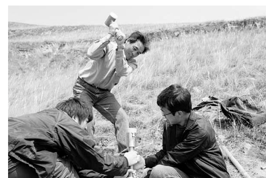
朱清科(中)在安装黄土坡面缓台微地形土壤水分监测仪器。
