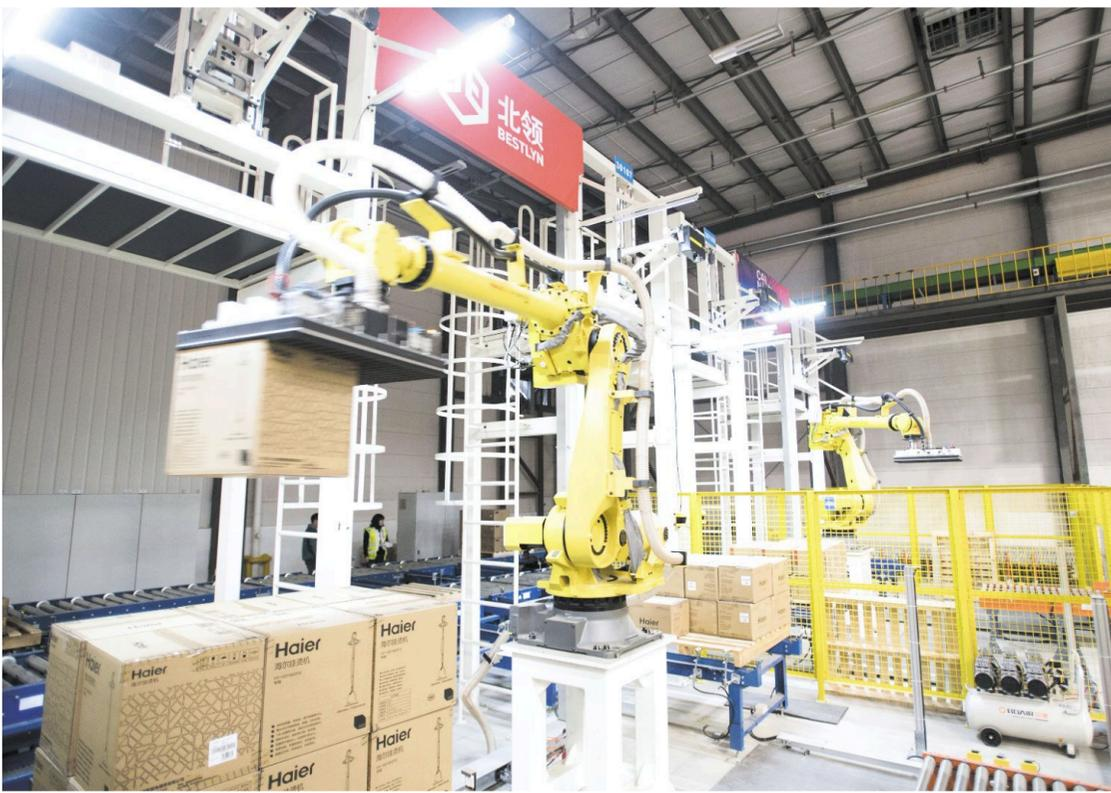
12月26日,在菜鸟网络武汉黄陂物流仓内,机械臂在进行搬运作业。近日,菜鸟网络在湖北武汉黄陂物流仓启用智能机械臂来搬运商品。据介绍,每组机械臂一个小时能搬运1000件商品,可以24小时不间断作业。这些机械臂的投入,有助于缓解高峰期货物处理压力,提高发货速度,被工程师亲切地称为“麒麟臂”。新华社记者肖艺九摄
