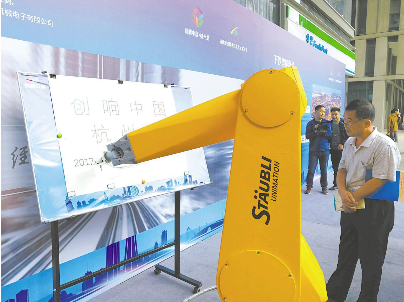
10月11日,由国家发展和改革委员会、中国科学技术协会、浙江省人民政府主办,浙江省发展和改革委员会、杭州市人民政府承办的2017“创响中国·杭州站”活动在杭州经济技术开发区(下沙)正式启动。图为史陶比尔展出的6轴多臂机正在喷涂活动主题。据工作人员介绍,该机可用于汽车喷涂、食品包装等专业生产线,其减速机电平位居世界前列。 本报记者张楠摄影报道
