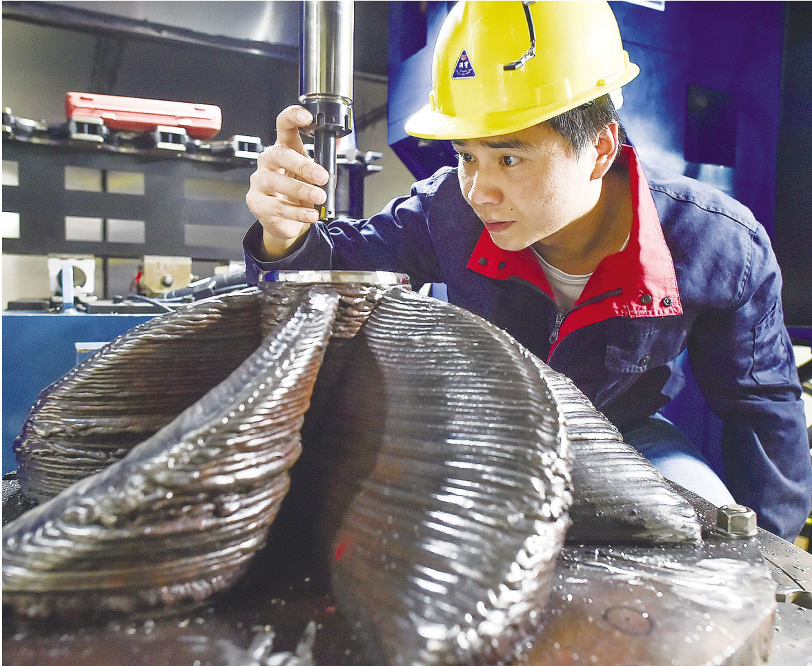
华中科技大学机械学院教授张海鸣通过在3D打印技术中加入锻打技术，于日前成功制造出世界首批3D打印锻件。
