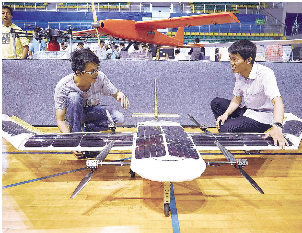
5 月 3 日,南昌航空大学学生在调试他们自主研发的可倾斜太阳能无人机。这款无人机解决了高速平飞与垂直起降的技术矛盾,使用太阳能作为能源动力,未来可广泛应用于农业、航拍等领域。
