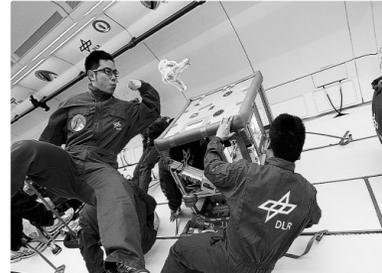
中科院太空增材制造技术试验队,利用每次22秒微重力环境,用自主研发的设备和工艺成功打印了目标样品。
