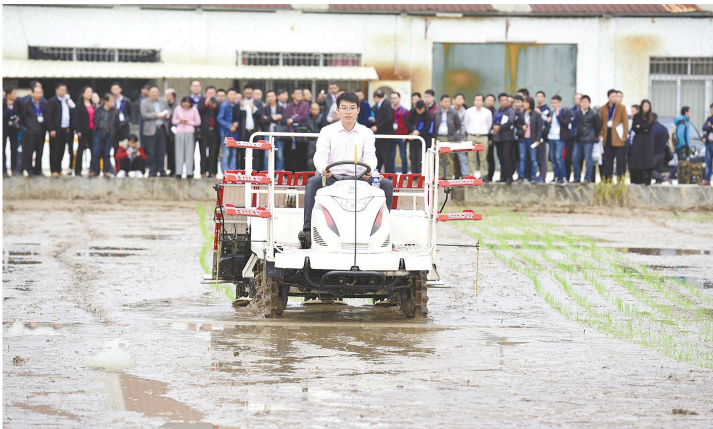
11月29日,由中国工程院农业学部和华南农业大学联合主办的2016水稻机械化直播技术国际研讨会在华南农业大学召开。研讨会吸引了9个国家的450多位代表参加。会上,两院院士共话农业现代化。记者从会上了解,中国工程院院士罗锡文水稻用的是他潜心研制的水稻精密穴直播技术及机具。该技术与机具免去了育秧、运秧和移栽等步骤,已在国内外推广应用。图为当天水稻种植机械化田间演示在华南农业大学增城基地的试验田进行。
