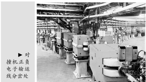
对撞机正负电子输运线分岔处
