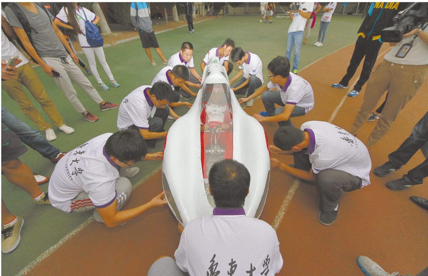
9月16日,山东烟台鲁东大学,试车手坐进驾驶座后,学生们正在为节能汽车固定整流罩。
