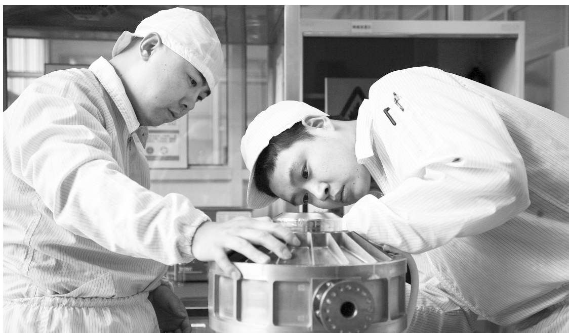
502所CMG团队在进行控制力矩陀螺装调。
