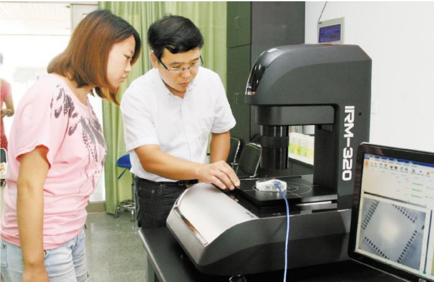
9月15日，科研人员正在调试红外显微热像系统。 当天，由上海大学纳微能源研究所国家“千人计划”特聘专家胡志宇带领团队研发的我国首台具有自主知识产权的红外显微热像系统，在沪通过专家验收。据悉，该系统在微纳米、生物、微电子、材料科学、医疗诊断、公共安全等领域具有广泛的应用前景。同时，这也是我国目前唯一能达到光学放大倍率为10倍、系统分辨率为4微米的相关产品，并可实现产业化。
