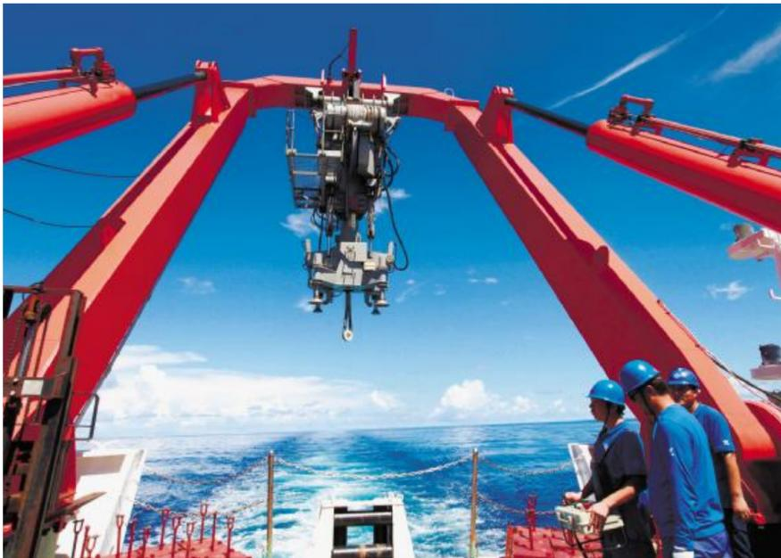
7月23日,水面支持部门的工作人员在“向阳红09”船的后甲板上开展A形架系统行进演练。“蛟龙”号的安全保障系统处于国际领先水平。紧急情况下,下潜人员可以通过操纵控制面板上的按钮把携带的抛载铁、蓄电池箱、采样篮统统扔掉。如机械手被缠住,“蛟龙”号将“断臂”,抛弃机械手。最糟糕的情况是陷入淤泥。这时,“蛟龙”号的报警系统会发射浮标到海面。母船立即到位,施救,确保把所有下潜人员营救回来。
