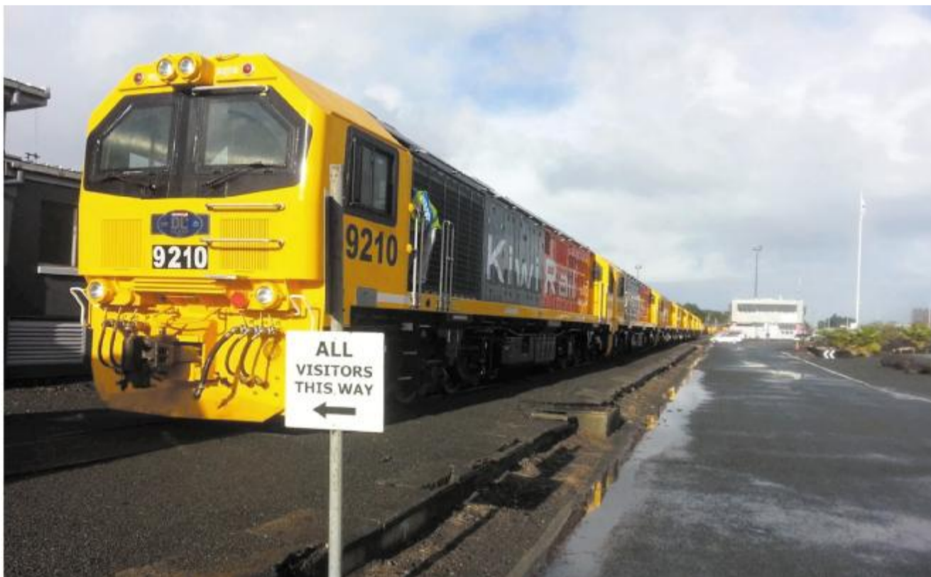
从7月初开始,中国北车大连机车公司派出7人组成的交车团队,开始对中国出口至新西兰的首批10台机车进行现场整备。据了解,中国大连机车公司拟为新西兰国铁KIWI RAIL公司制造40台世界上装车功率最大的窄轨内燃机车。机车采用低排放、低噪音、高舒适度的设计,最大功率为2700千瓦,最高运行时速100公里。按计划,从9月开始,40台机车将全部在新西兰投用。本报记者刘万生 通讯员邢毅摄影报道
