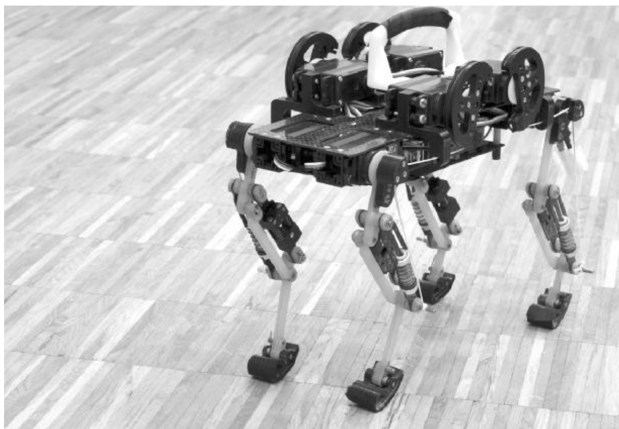
当地时间2013年6月17日,瑞士洛桑联邦理工学院的 researchers 研究出一款以家猫为原型的“cheer-cub”机器人,其腿部经过研究员特殊设计,可以像家猫那样走猫步,使它在凹凸不平的地面上也能保持平衡。而且,它的速度也很快,每秒可以移动是自身长度7倍的距离。CFP供图
