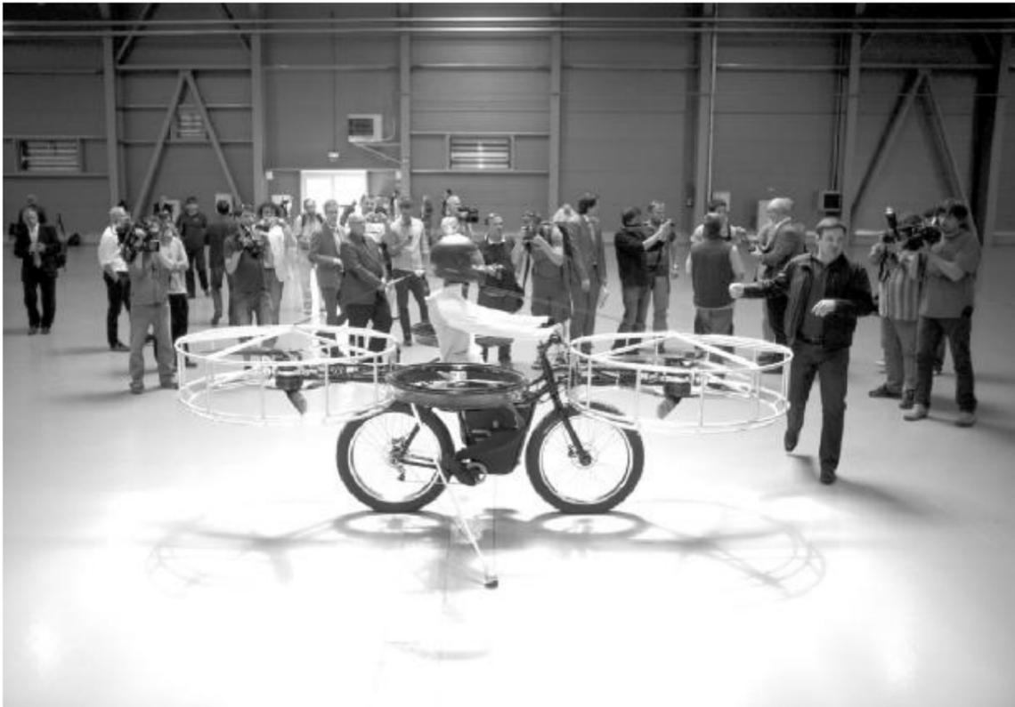
布拉格当地时间6月12日,由捷克三家公司联合制造的“飞行单车”进行试飞。这辆飞行单车装有4个10kW的主电动机、2个3.5kW的稳定电动机,可持续飞行3-5分钟。CFP供图
