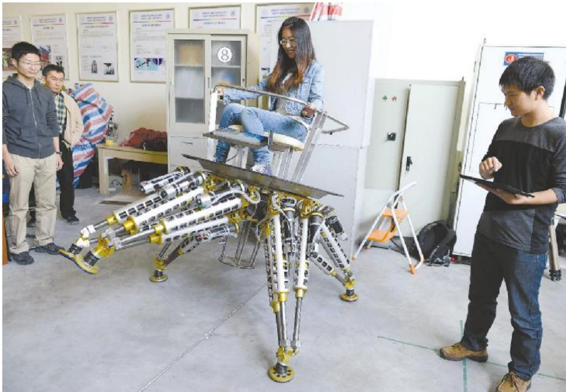
10月28日,在上海交通大学机械与动力学院重装所,工作人员在用“六爪章鱼”救援机器人进行载人试验。当天,由上海交通大学研发的具有自主知识产权的“六爪章鱼”救援机器人正式亮相。“六爪章鱼”机器人高约1米,由18个电机驱动,通过远程控制使用,能够灵活地沿各个方向稳定行走,速度可达1.2千米/小时,负重达200公斤。据悉,“六爪章鱼”具备深入复杂危险环境的工作能力,可在化学污染、水下和火灾等环境下完成探测、搜索和救援等任务。
