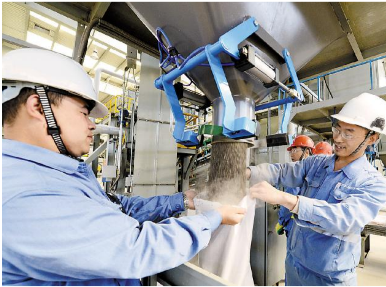
10月16日,大钢哈斯科钢渣综合利用公司当班工人在对生产出来的专用化肥进行包装。近日,由大钢集团和美国哈斯科公司投资建设的钢渣综合利用项目进入试生产阶段。这是中国首个、全球最大的钢渣综合利用项目。投产后,实现回收不锈钢废钢2万吨,生产钢渣肥料50万吨、路基材料34万吨、钢渣超细粉30万吨等。这些均为高附加值产品,市场前景良好。特别是具有特殊功效的专用肥料,对于辅助“三农”、改善土壤结构具有重要意义。张轩翰摄(新华社供图)
