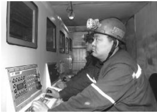
薄煤无人值守自动化开采,减轻了工人劳动强度,确保了人员安全,并使回采率达到了 98%。图为自动化开采操作室。
