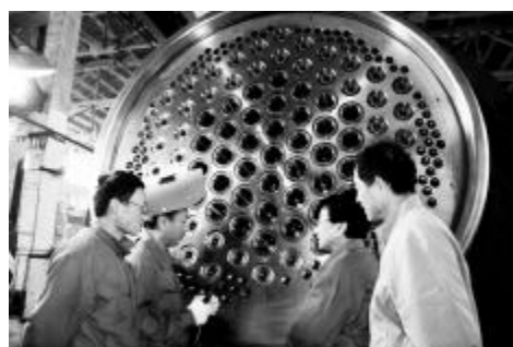
中国实验快堆堆内构件生产
