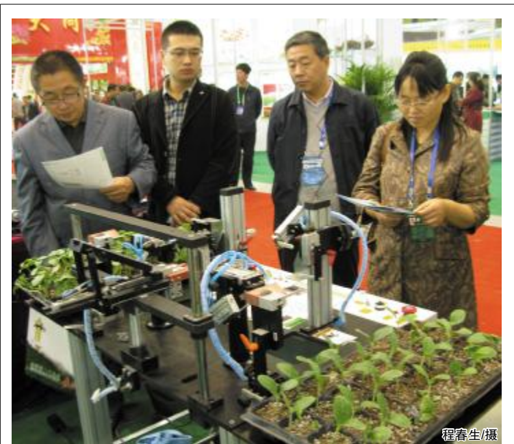
在刚刚召开的山西省第二届特色农产品交易博览会上,“新技术推广”展厅的一台蔬菜自动嫁接机吸引了不少人的目光。研发该智能嫁接装备的技术人员不停地为观众做现场演示,只要轻轻触发脚踏开关,装置将会对砧木和接穗进行自动夹持、切削、对接和上夹作业,便可轻松完成嫁接作业。
