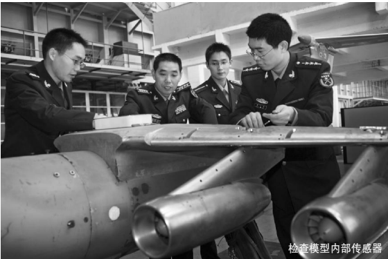
检查模型内部传感器
